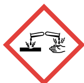
Stoffe/Gemische, die auf Metall korrosiv und hautätzend wirken
